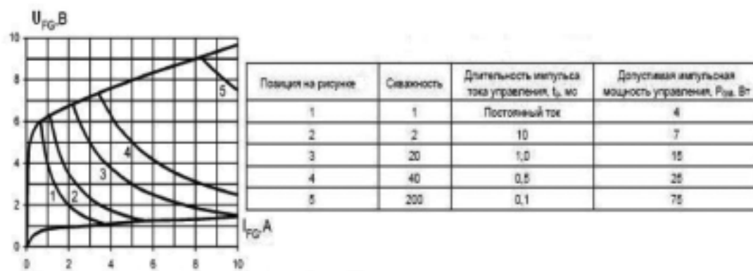
Рисунок 12: Предельные характеристики цепи управления.
